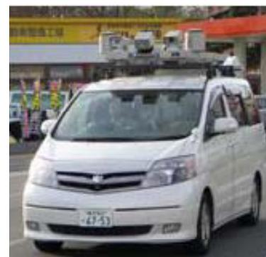
実験中の車載レーザ装置
