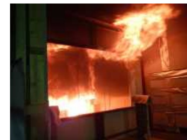
内装制限により開口火炎噴出の遅延化、上階延焼の遅延化が期待(実証的検討)
