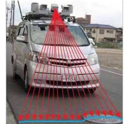
高精度GPS移動計測装置
