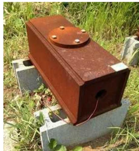
実験に使用した箱桁モデル
