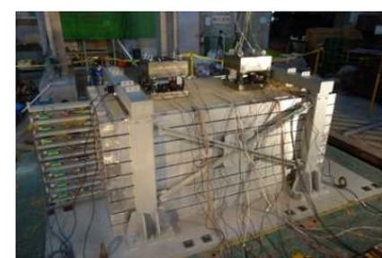
既存工法の耐震性能・適用性検証(例:せん断土槽を用いた実験)
