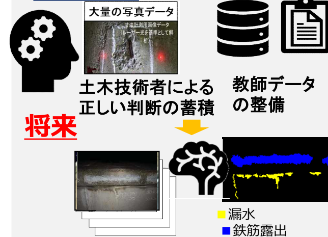
AIによる損傷抽出と区分の自動判別
