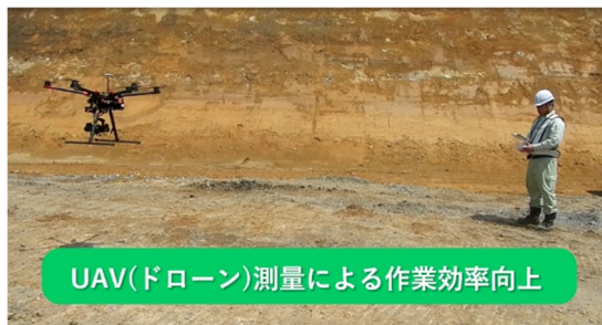
写真-2 UAVでの測量
