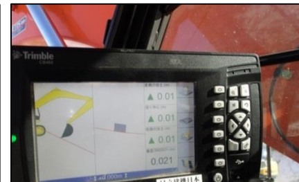
盛土法面整形 3D-MGバックホウ
