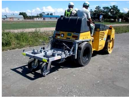
衝撃加速度法による 盛土締固め計測機
