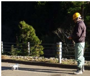
ドローンによる測量
