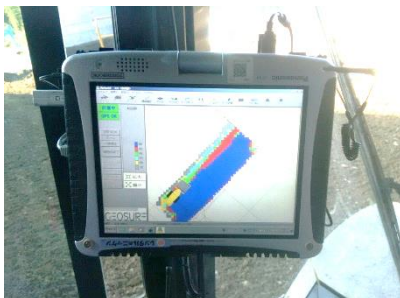
ローラーの転圧管理モニター
