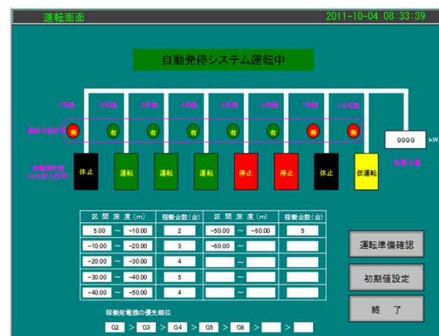
発電機自動発停装置表示例
