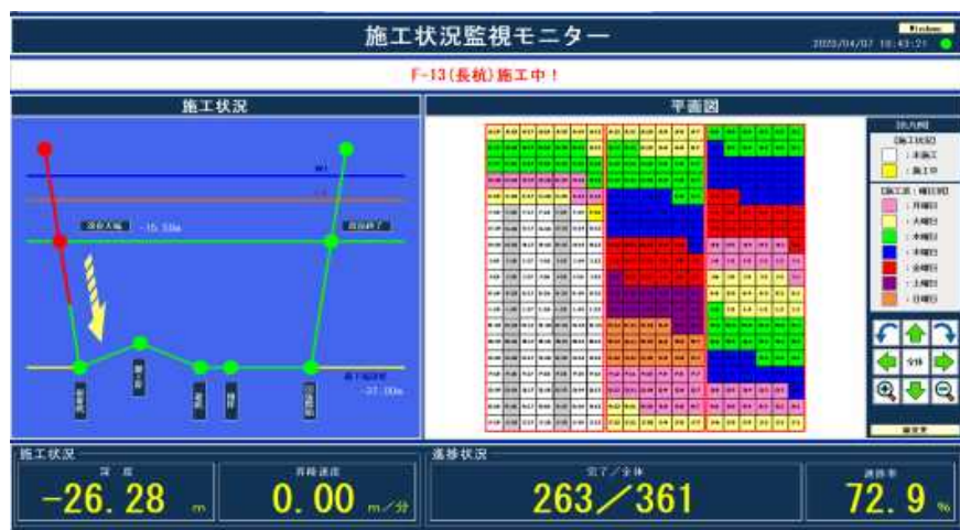
施工状況監視モニター表示例
