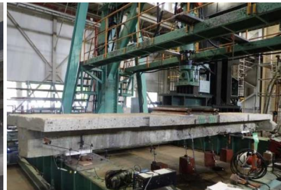
解体後 土木研究所での破壊試験
