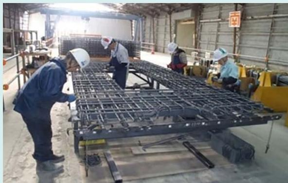
従来の鉄筋組立状況(作業員による組立)
