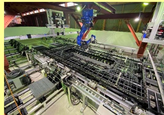
ロボタラスによる鉄筋組立状況
