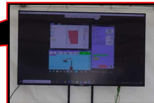
現実空間と設計データ(改良区画割)を高精度にマッチングし、ビジュアルに確認できる高精度屋外AR(拡張現実)システム「トリブルサイドビジョン(Trimble SiteVision)」により可視化。
