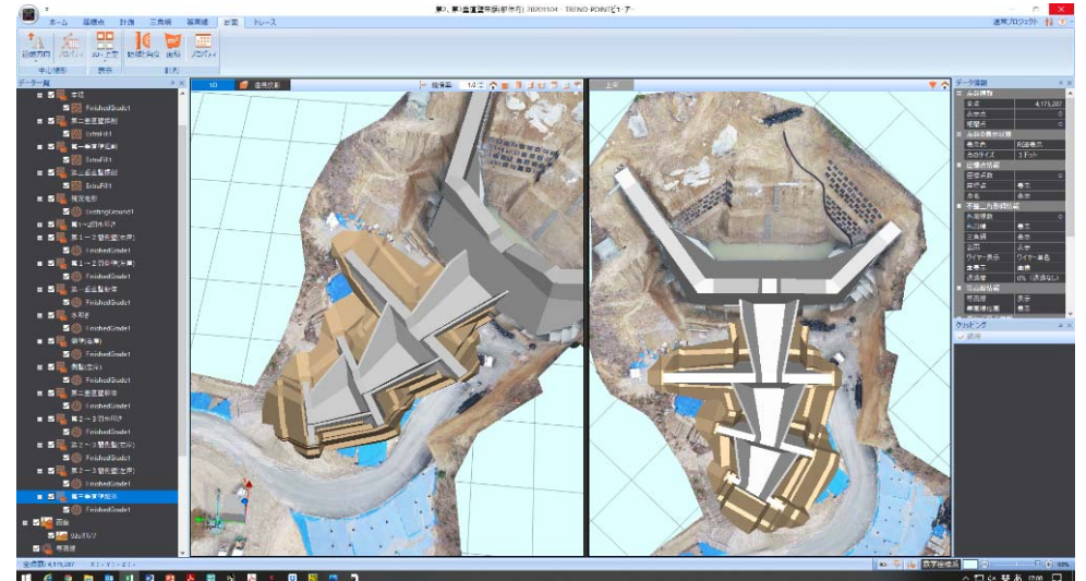
【現況点群データと3D設計データの重ね合わせ】
