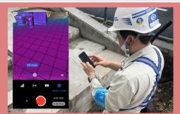
スマホのLiDAR機能にてリアルタイム に現場の点群を取得し各システムに登録 して活用する。
