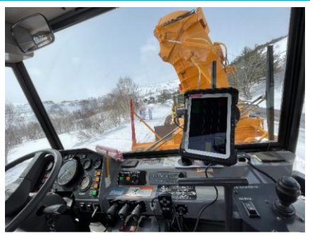
除雪車内の端末設置状況
