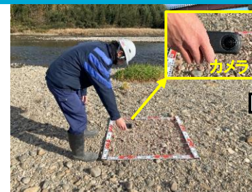
画像解析（AIによる河床材料の抽出・計測）
