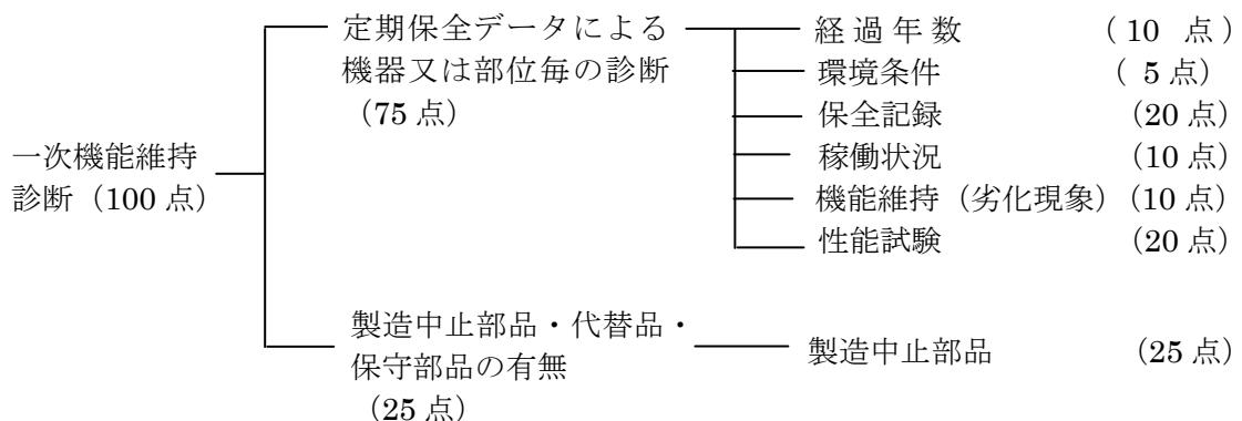
過去の「定期保全データ」は、使用期間把握の為の「経過年数」、置かれた環境の経歴把握の為の「環境条件」、過去5年間の故障、修理等の経歴による「保全記録」、直近2年間の点検時の測定データによる変化のトレンドを示す「性能試験」、異音・異臭等の「稼働状況」、変色・変質・腐食粉塵付着等の「機能維持」、電圧測定、絶縁抵抗測定等の「性能試験」に分類される。
