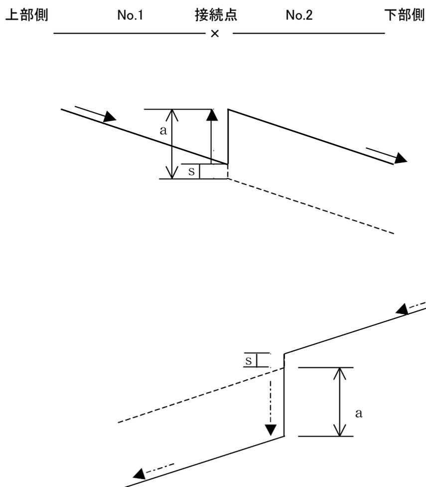
No.1とNo.2のケーブルの後方散乱光レベル差を  $a$ 、接続損失を  $s$  とすると、上部側より測定した場合は  $(a - s)$  の波形が現れ、下部側より測定した場合は  $(a + s)$  の波形が現れる。
