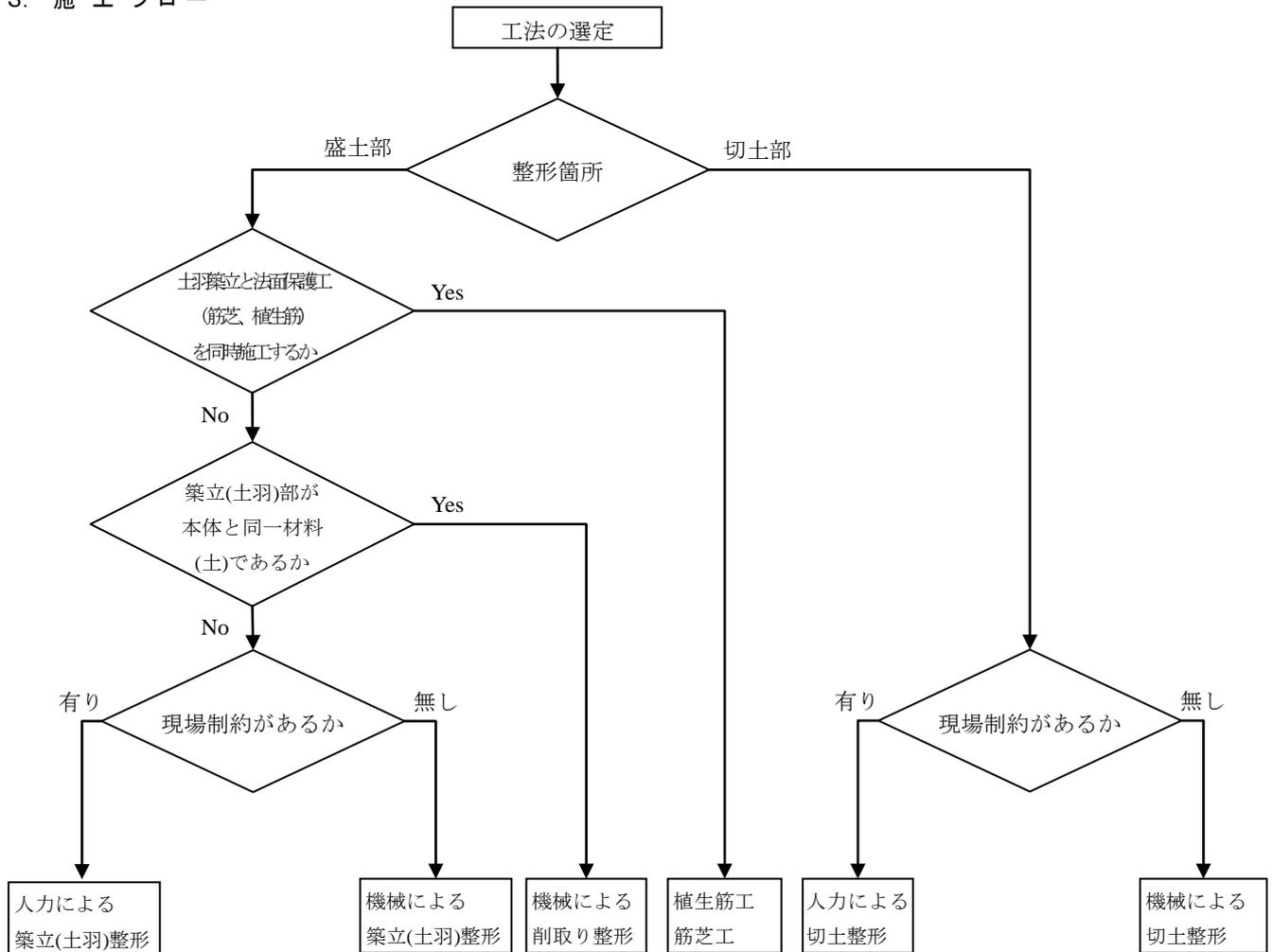
図3-1 法面整形工 工法選定フロー図
