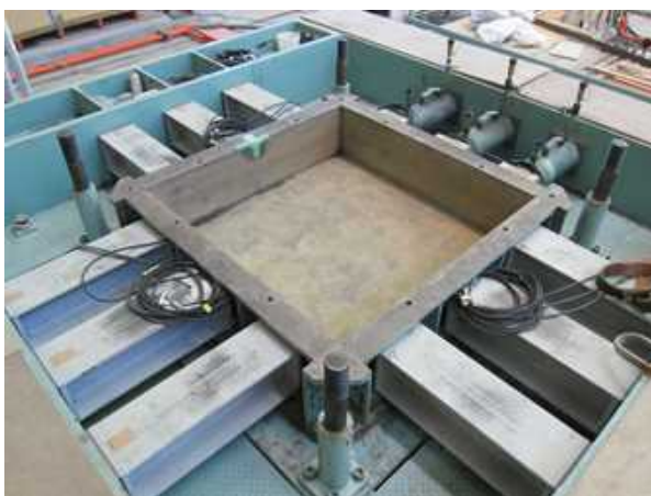
写真 3.6.1 二次元载荷試験装置
