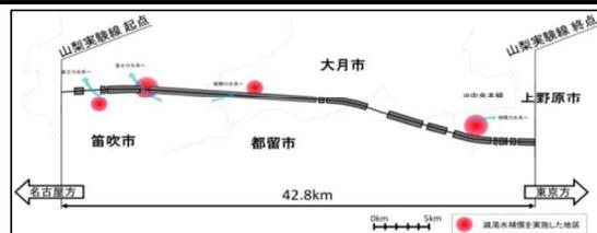
○ 山梨実験線や新東名の工事において、一部で局所的に水枯れが発生したが、いずれも、トンネルの近傍での事象。
