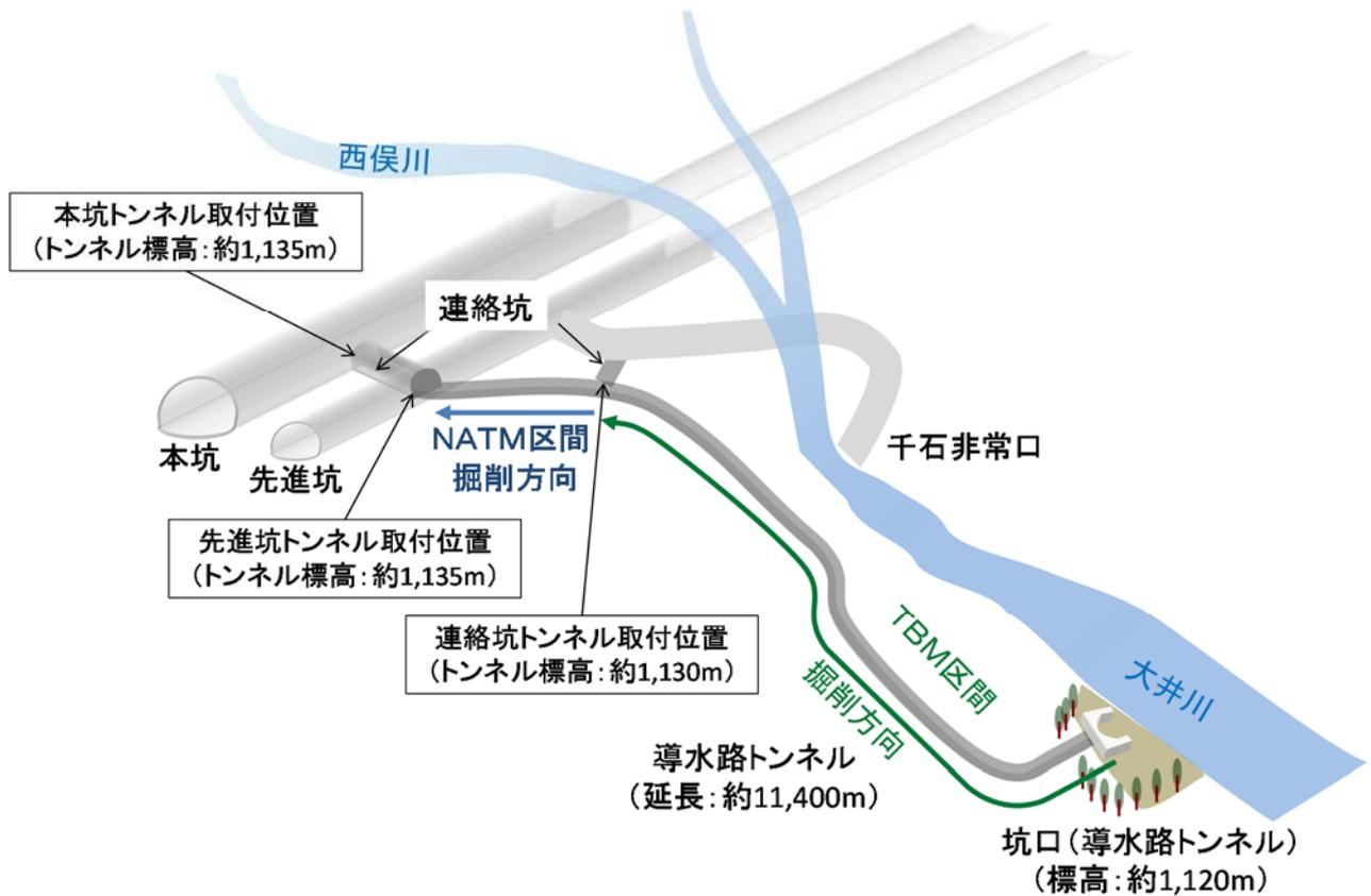
図 4.11 導水路トンネル 概念図
