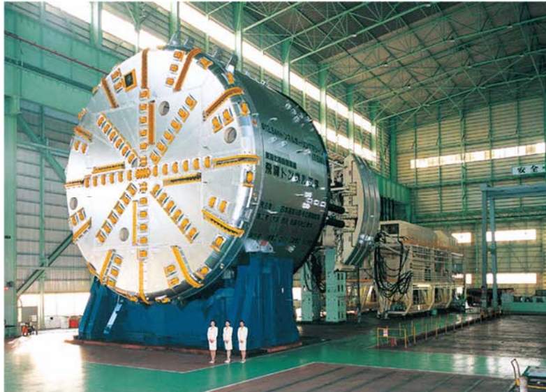
写真2 飛騨トンネル本坑TBM（ \phi 12.84\text{m} ）
