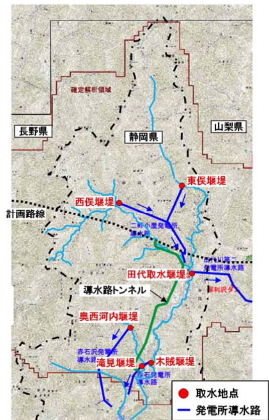
図 20 既設導水路トンネル・取水地点
