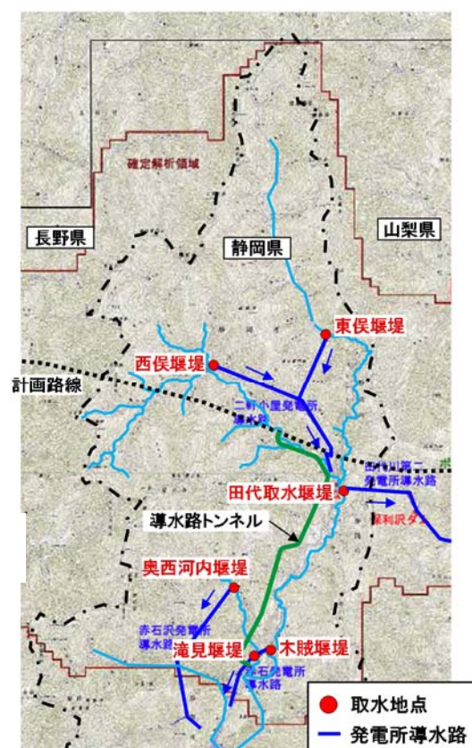
図 5-20 既設導水路トンネル・取水地点
