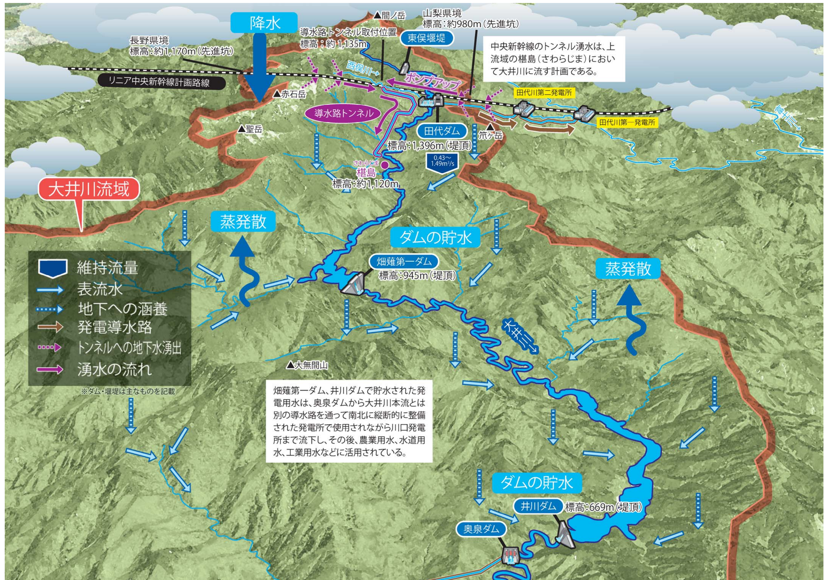
図 2.29 大井川流域の水循環の概要図 <鳥瞰図・井川ダム上流側>
