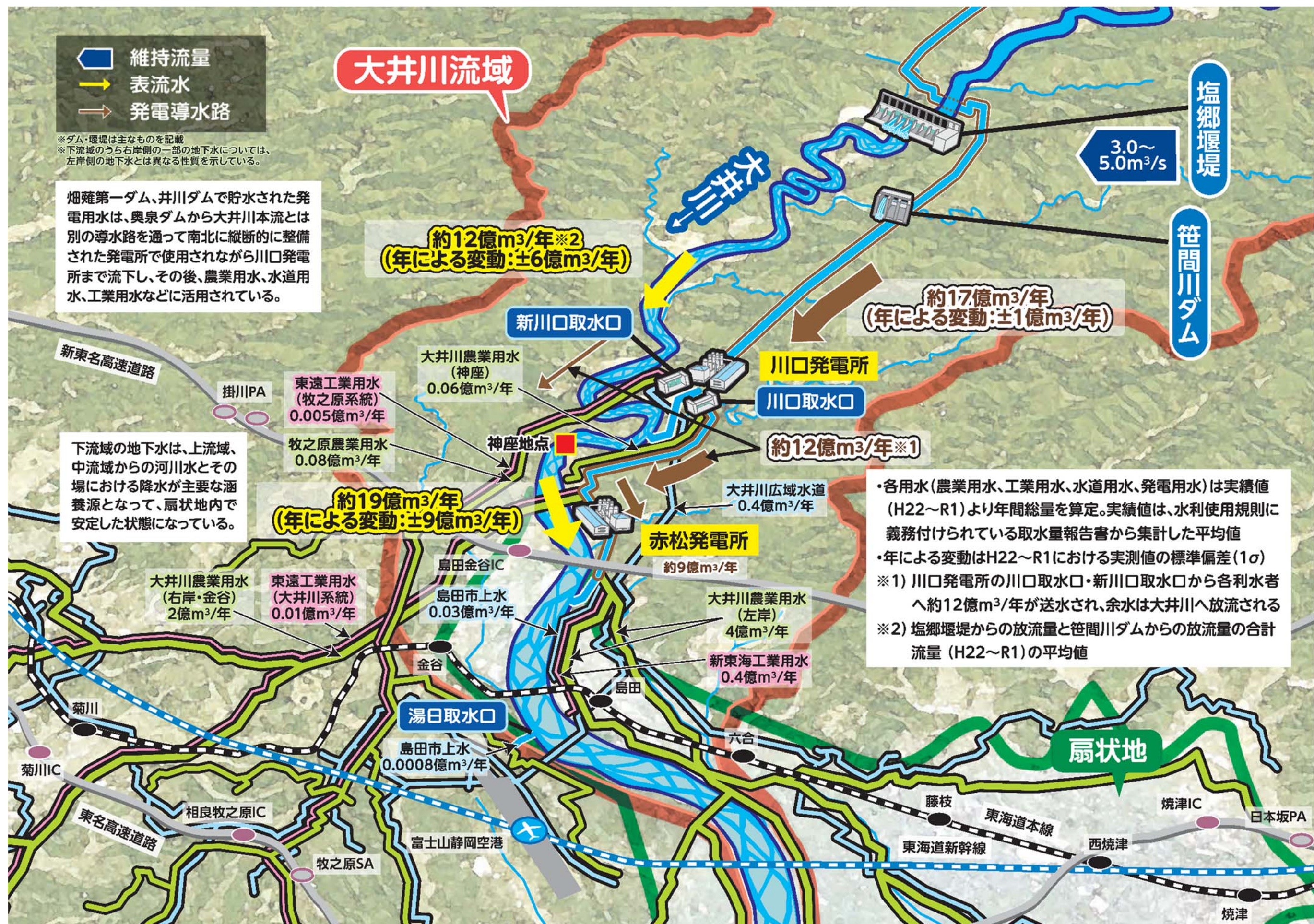
図 2.31 大井川流域の水循環の概要図 <下流利水者取水口付近拡大図>
