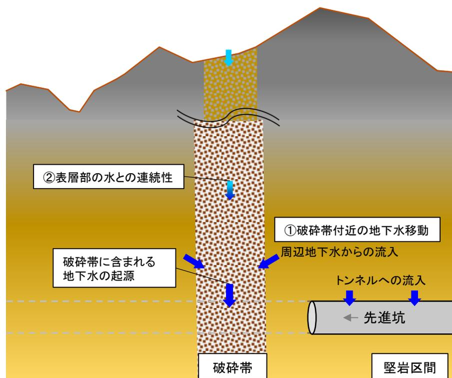
図 7.11 破碎帯に含まれる地下水の起源の推定（イメージ）
