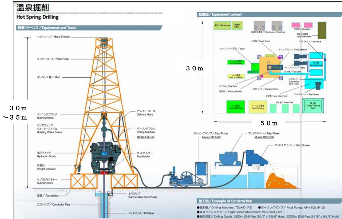
図 8-8 深井戸掘削設備のイメージ
