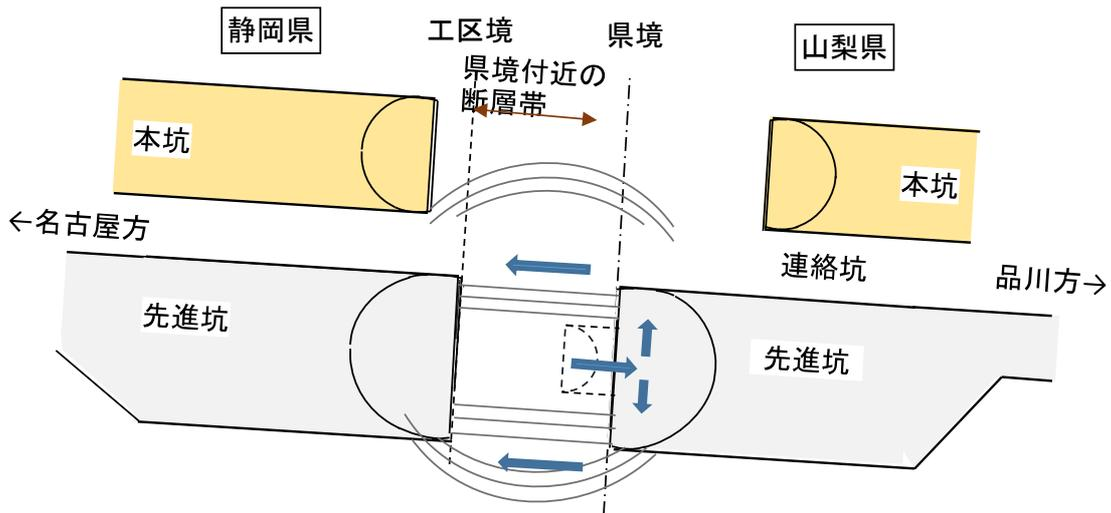
図 8-5 長尺ボーリングからの揚水検討図
