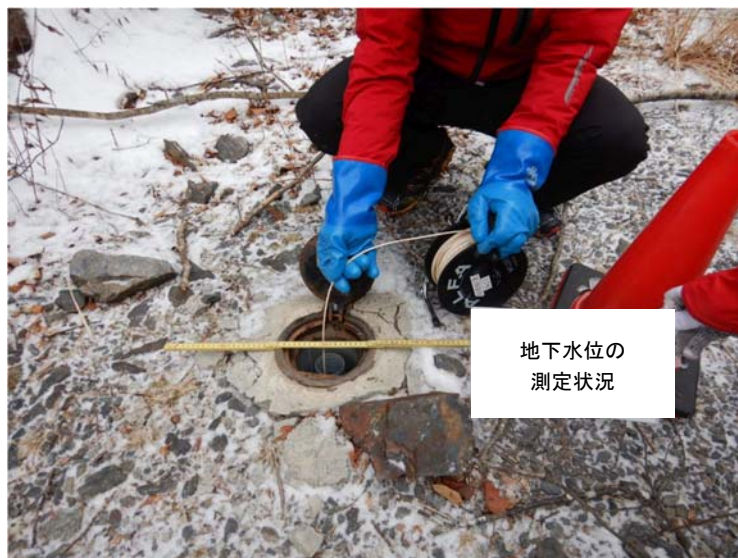
写真 3.2 地下水位の測定状況
