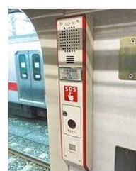
【非常通報装置】
