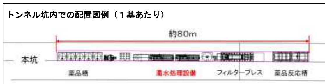
図 4.57 濁水処理設備の配置計画（仮に 3 \text{ m}^3/\text{秒} の濁水が発生した場合）
