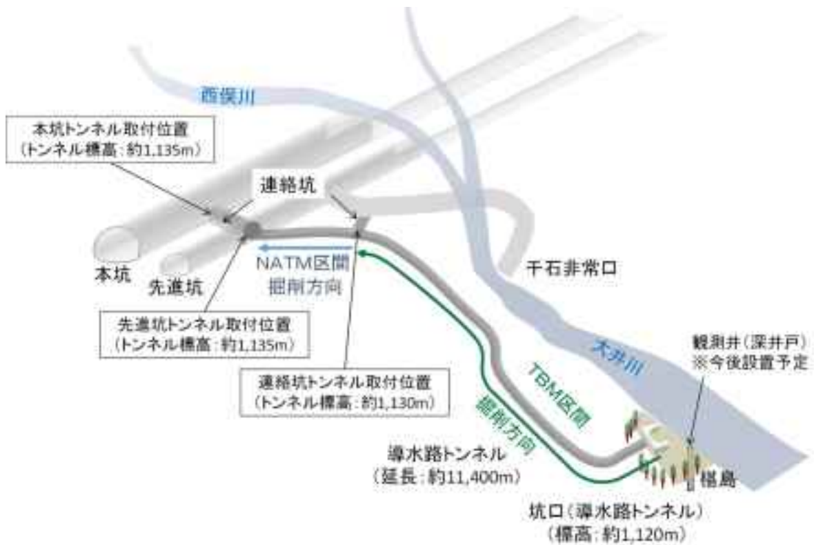
図 2.5 導水路トンネル 概念図
