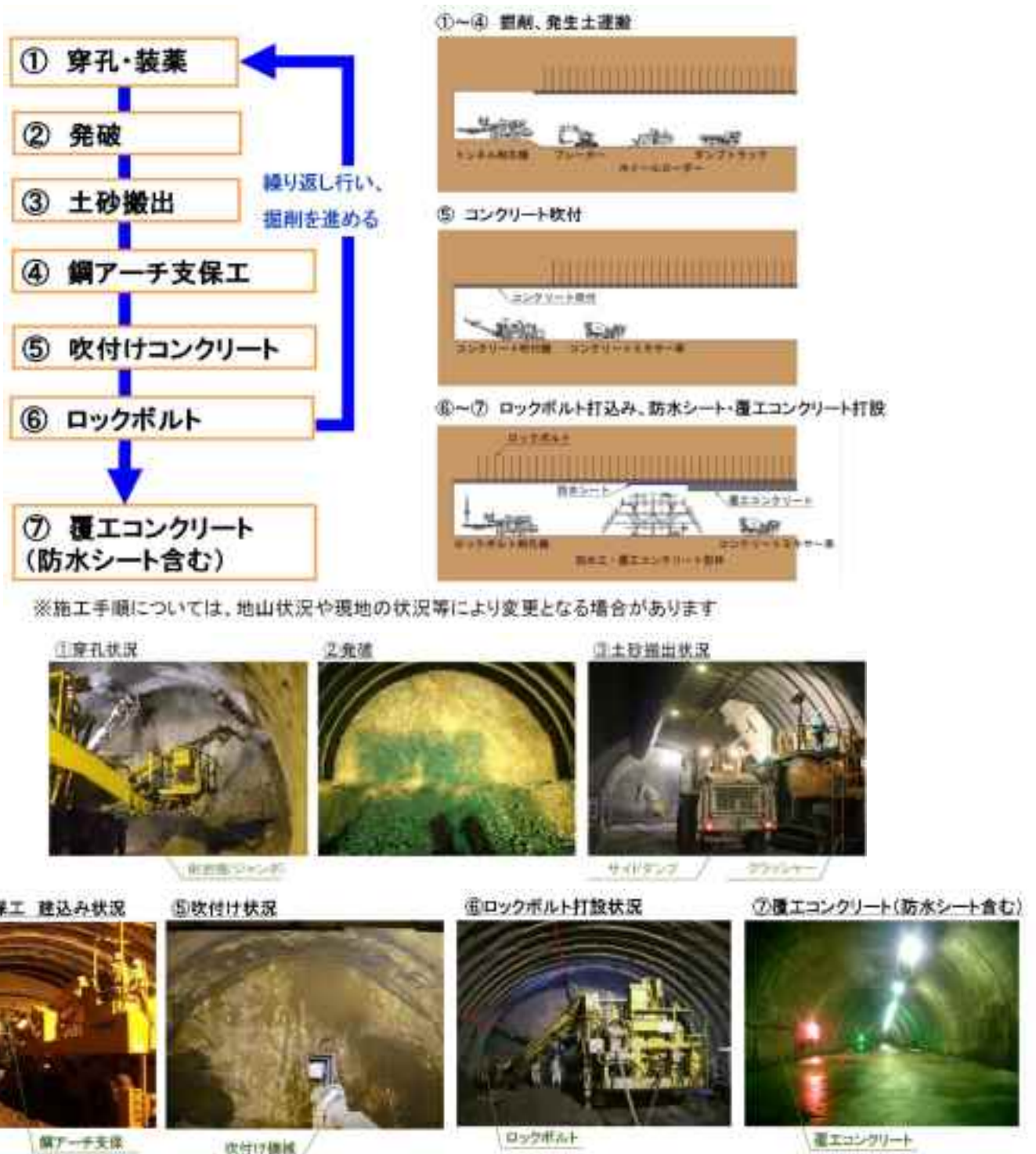
図 2. 8 NATMの標準的な施工手順
