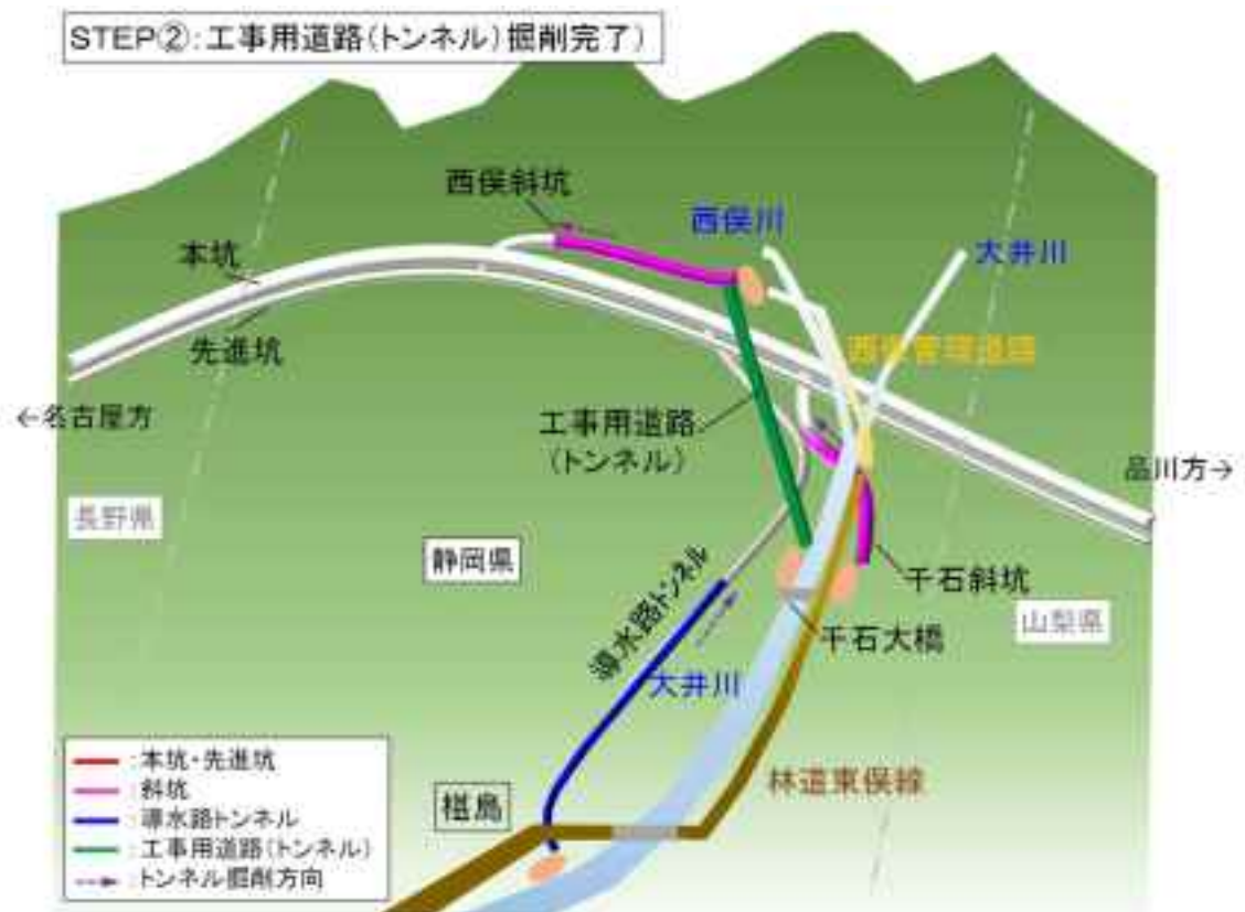
図 2.10 トンネル工事の進捗図 (STEP②)
