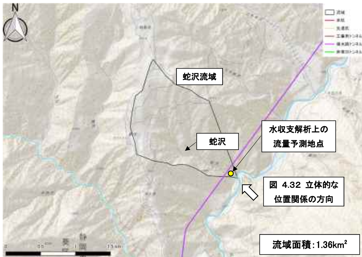
図 4.30 蛇沢の流域と各トンネルとの位置関係（平面図）
