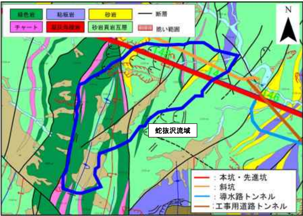
図 4.12 蛇抜沢付近の地質平面図
