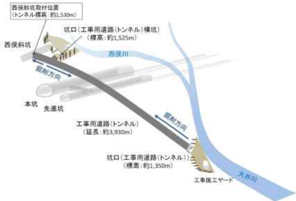
図 2.6 工事用道路（トンネル） 概念図
