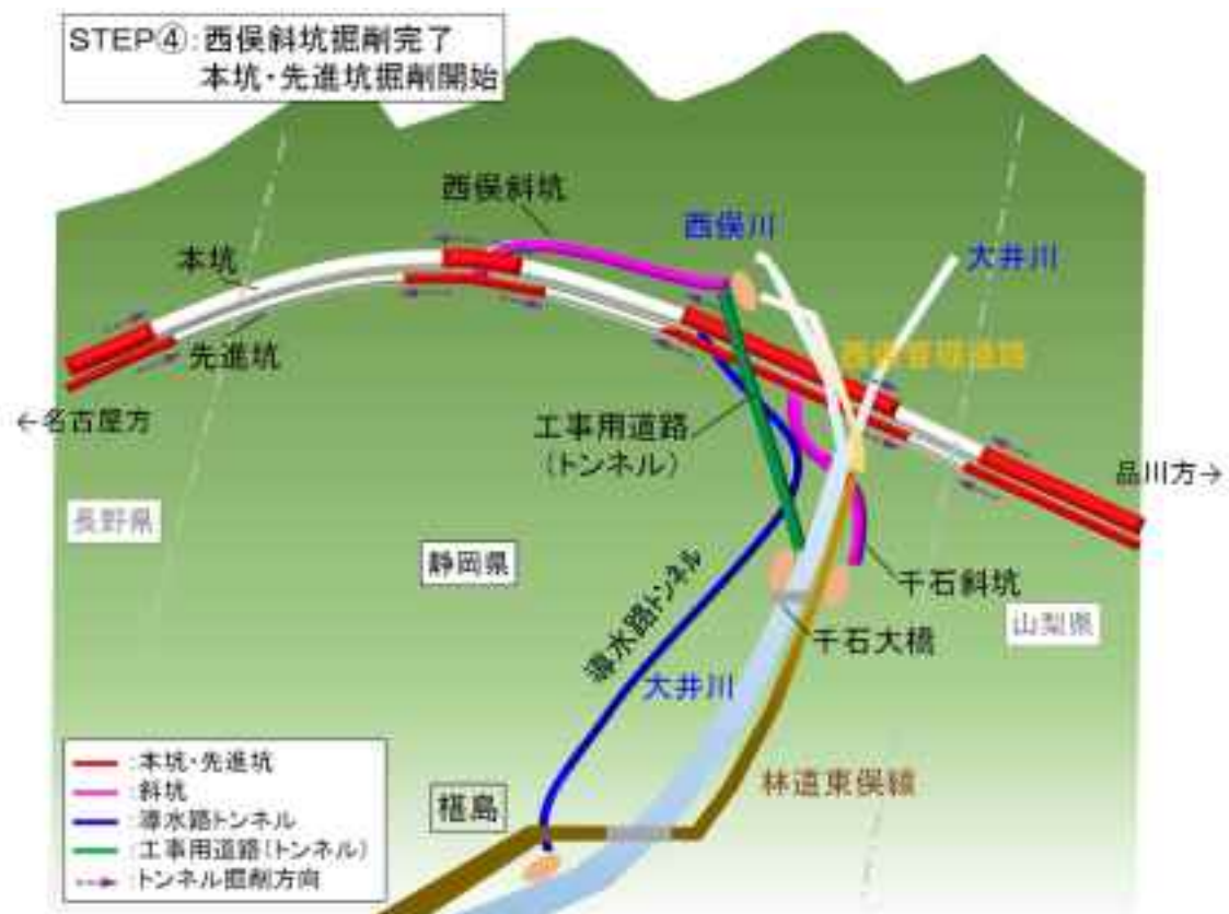
図 2.12 トンネル工事の進捗図 (STEP④)
