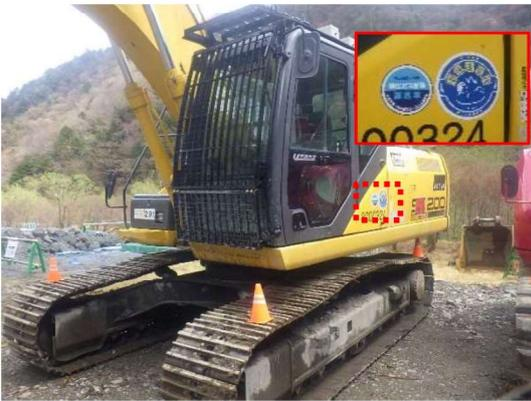
写真 5-1-2 排出ガス対策型、低騒音型建設機械の採用
