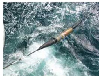
海底地震計を用いた 新幹線早期地震検知
