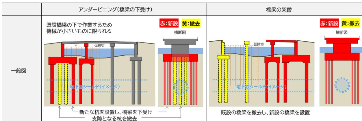
図 橋梁の基礎杭の施工イメージ
