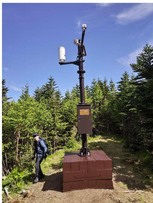
図 20 雨量計・積雪深計等の設置状況（千枚小屋付近）
