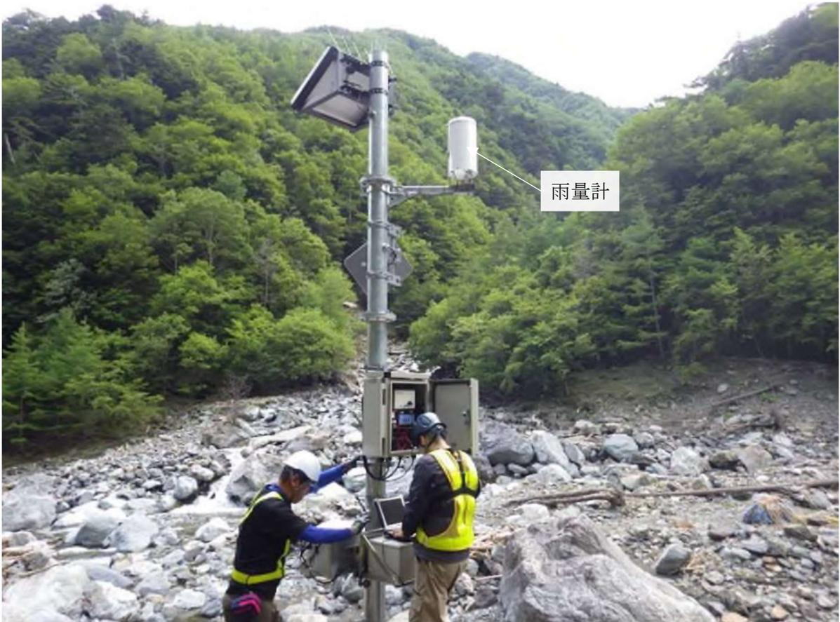
図 9 常時監視カメラ、雨量計の設置状況（蛇拔沢）
