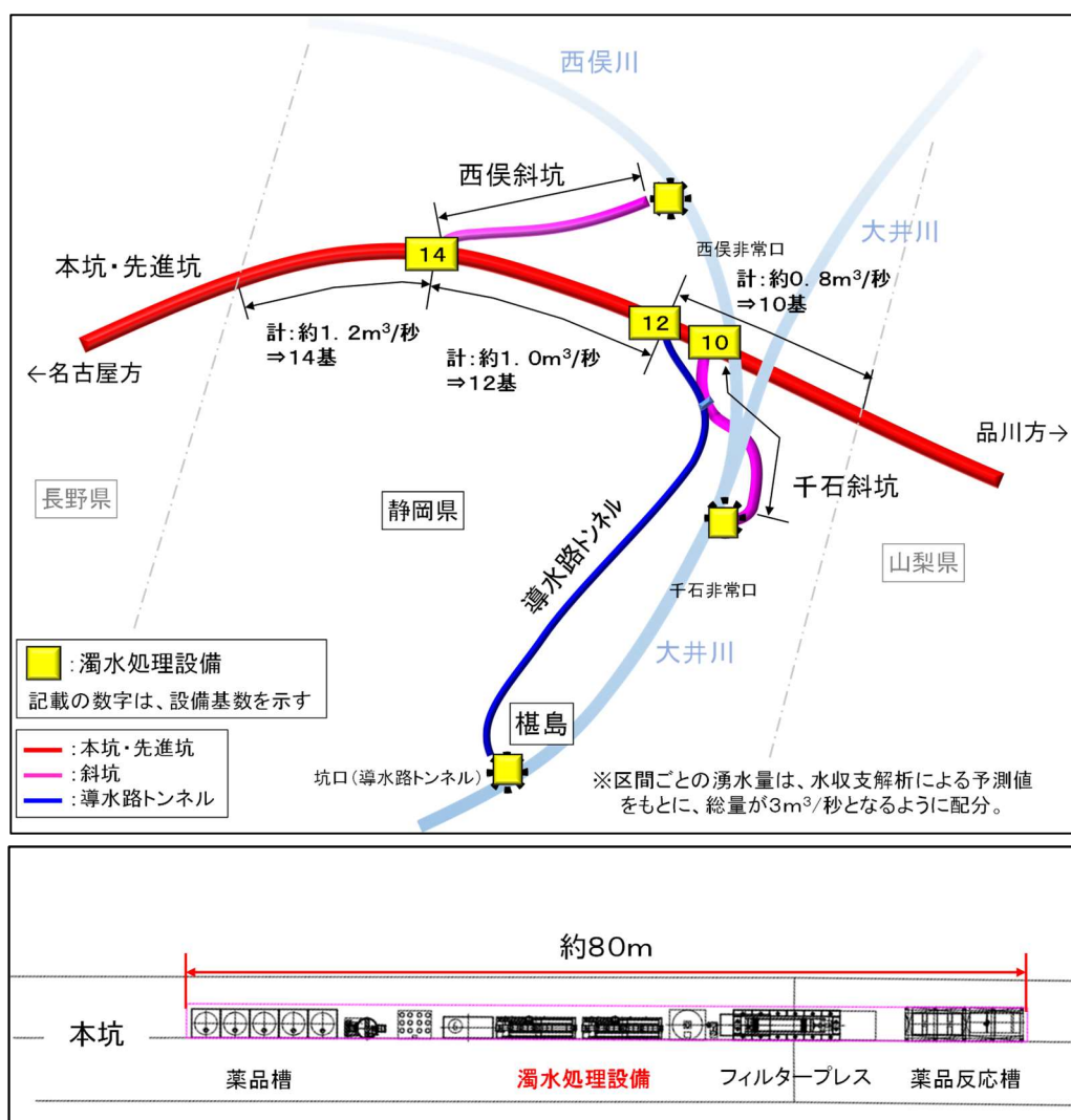
図 38 濁水処理設備の配置計画（仮に 3 \text{ m}^3/\text{秒} の濁水が発生した場合）
