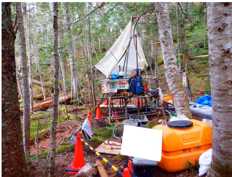
図 43 ボーリング調査実施状況（駒鳥池付近）
