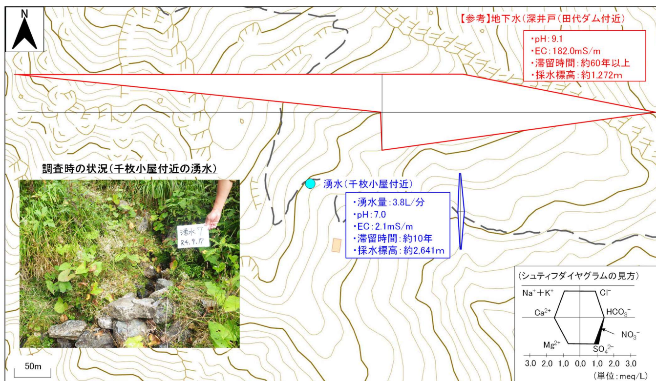
図 62 成分分析の計測結果まとめ(千枚小屋付近の湧水)
