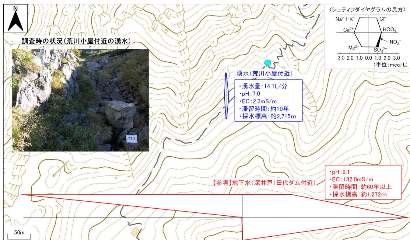
図 63 成分分析の計測結果まとめ(荒川小屋付近の湧水)
