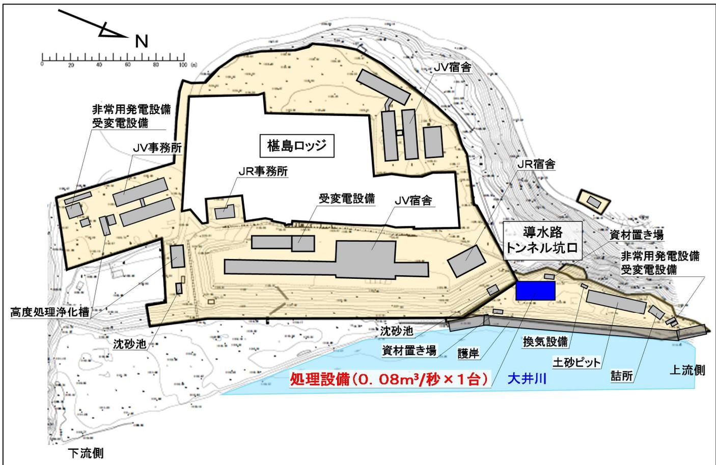
図 5.10 (3) 樫島ヤード内での処理設備設置計画 (トンネル掘削開始時)
