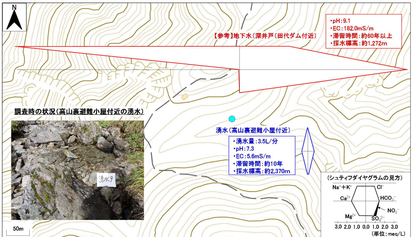
図 4.62 成分分析の計測結果まとめ(高山裏避難小屋付近の湧水)
