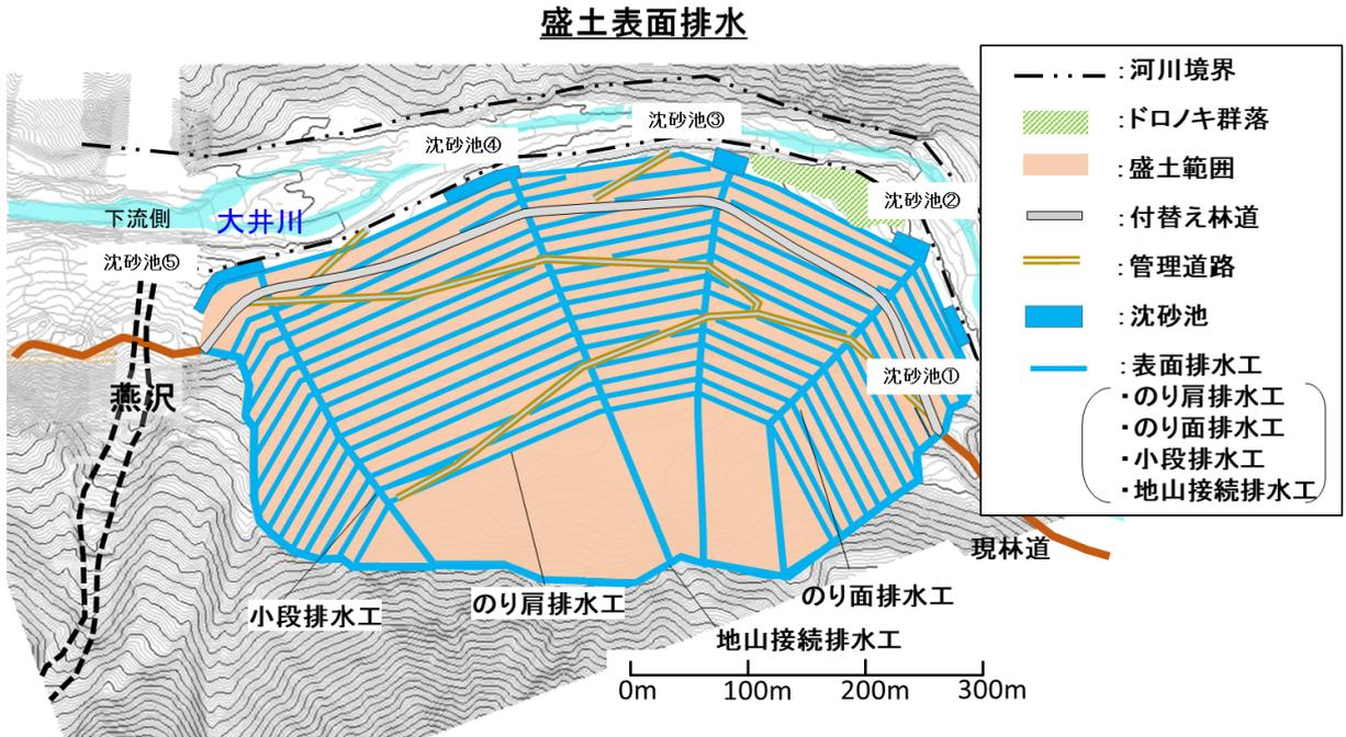
図 1-4 ツバクロ発生土置き場 計画平面図
