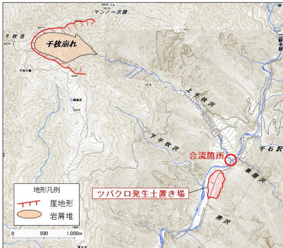
図1-14 ツバクロ発生土置き場と崩壊地（千枚崩れ）との位置関係
