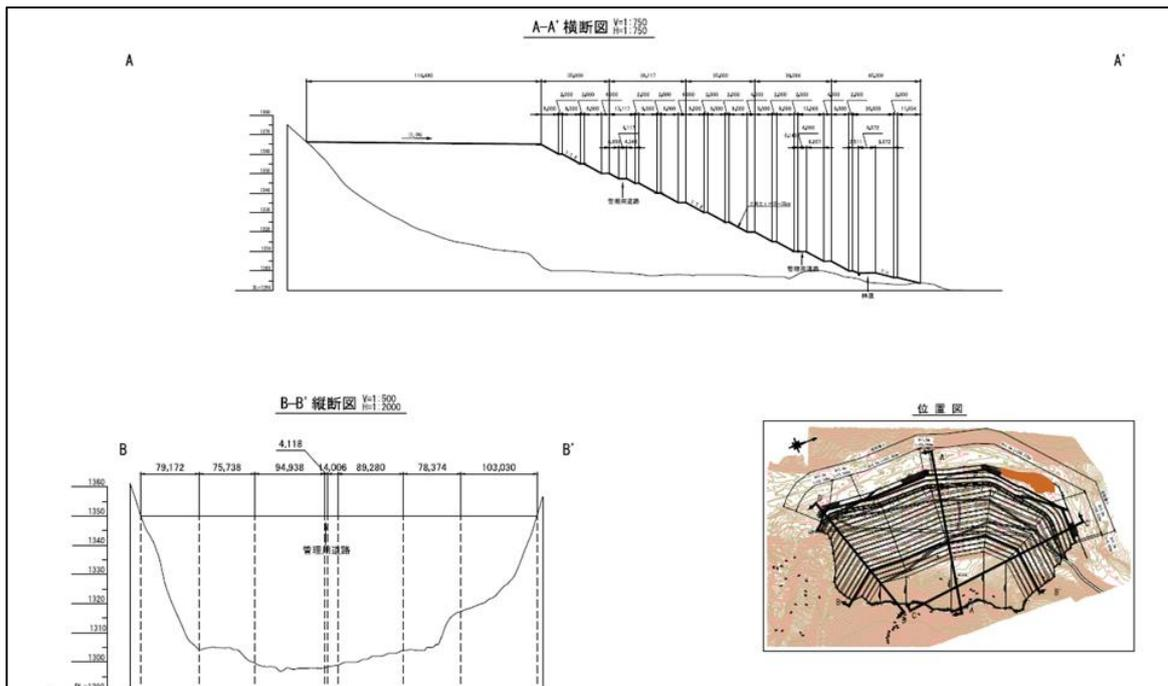
図 1-5 ツバクロ発生土置き場 縦横断面図
