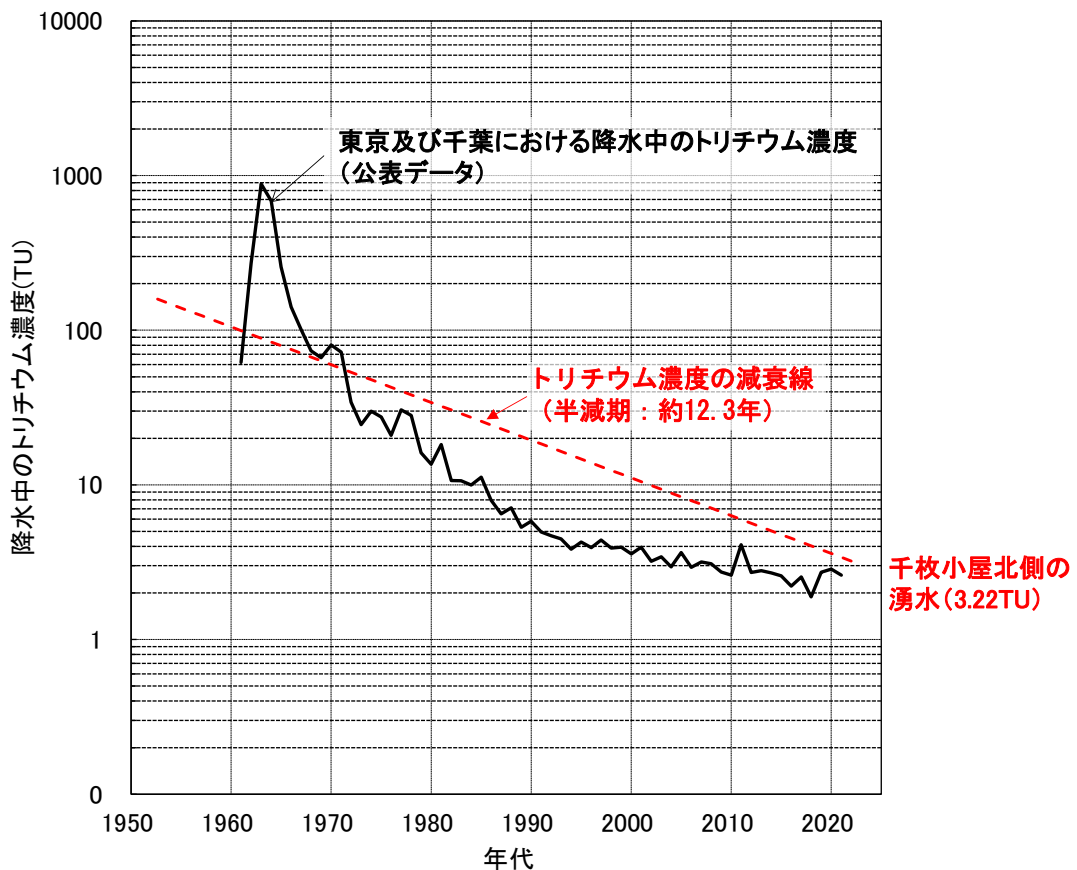
図 4.76 トリチウムによる滞留時間の分析 (千枚小屋北側の湧水)
