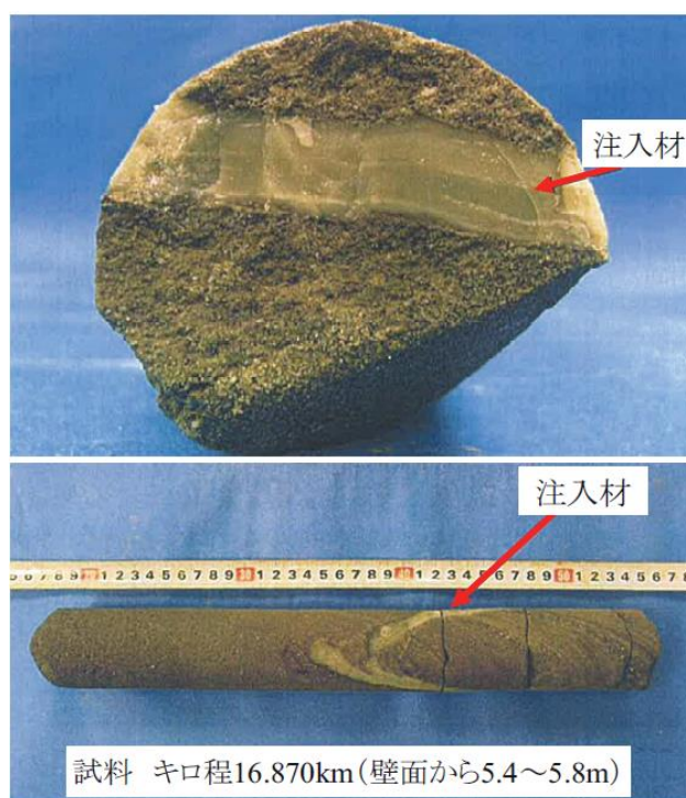
図 3-15 施工 30 年後に採取した直後の試料の状況 7
