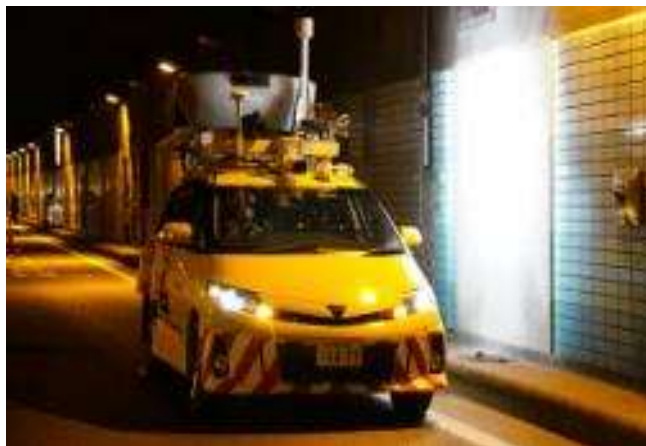
道路トンネルのひび割れデータ取得状況
