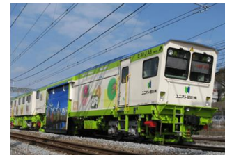
大型保線機械による整備
