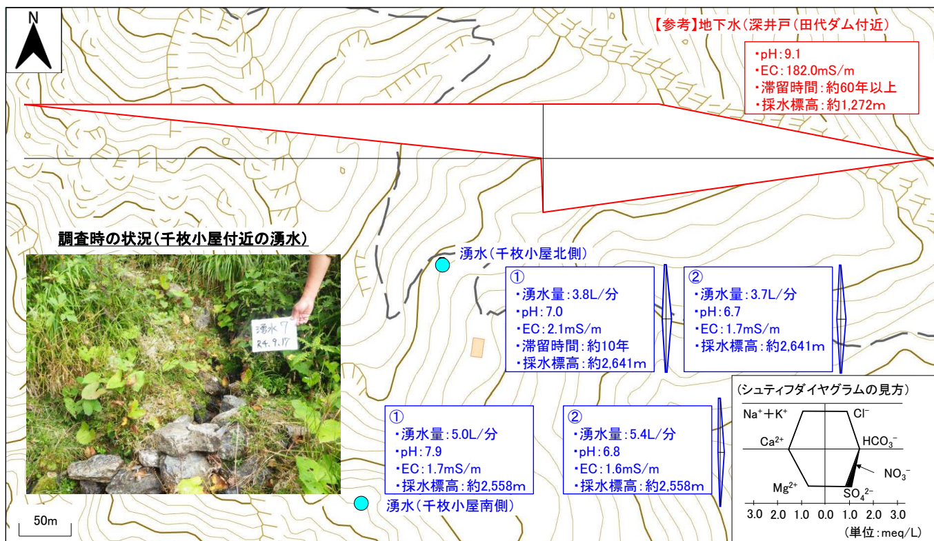
図 4. 7 2 成分分析の計測結果まとめ (千枚小屋付近の湧水)
