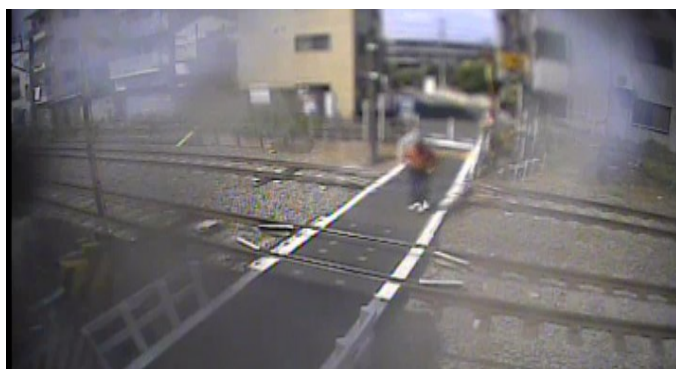
写真-1 誤検知パターン 2 水滴の侵入
