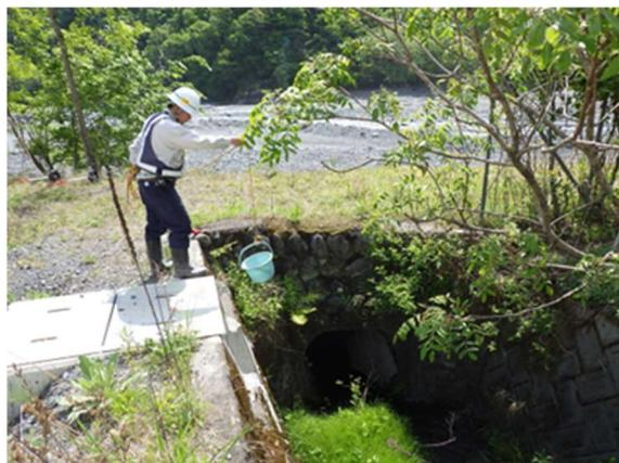
写真 参 2 放流する水の水質の確認
